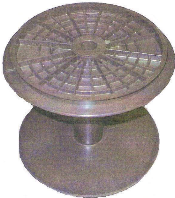
Vamatex = 2248002 - VA220 Smit / N.P = PNO20113 Øe = 220mm -- Øi = 44mm Li = 163mm -- Hole = Ø20mm
