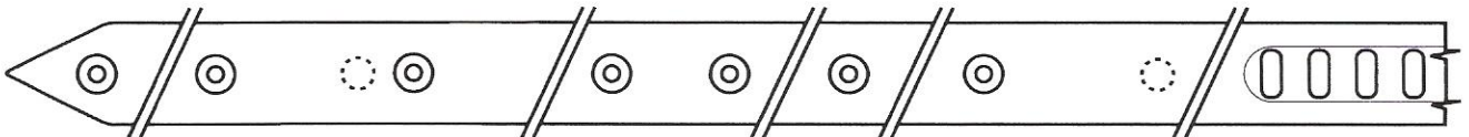
Nastro VAMATEX - Tipo 9000 Plus Destro/Sinistro con punta in carbonio, spessore 3 mm Art. N207 VAMATEX rapier tape - Type 9000 Plus Right/Left with carbon point, thickness 3 mm Art. N207
